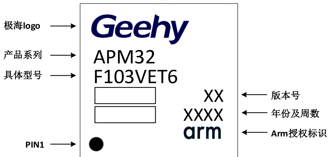
图22 LQFP100 - 100 引脚，14 x 14mm 封装标识
