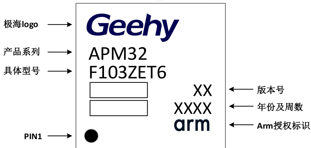
图19 LQFP144 -144 引脚, 20 x20 mm 标识图
