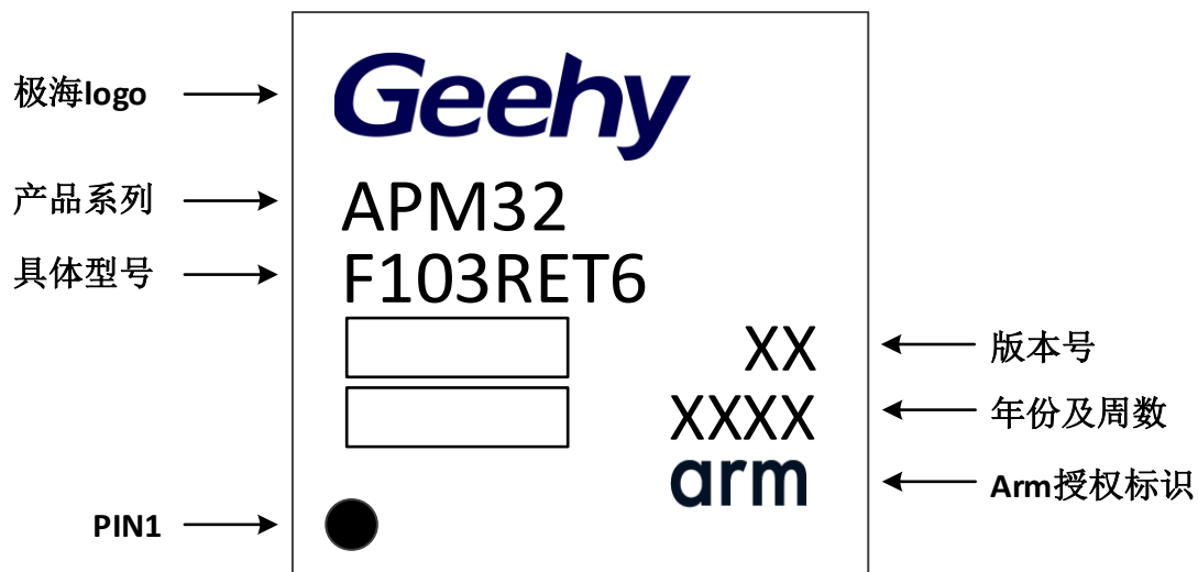
图25 LQFP64 - 64 引脚，10 x 10mm 封装标识
